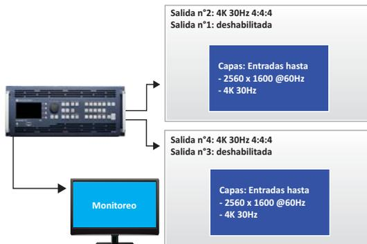
Una salida HDMI 4K 30 Hz 4:4:4 y dos salidas 2K
